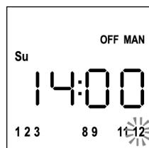
6. Wanneer kanaal **12** is ingeschakeld **MENU** indrukken om te bevestigen. De kanalen die voor de groep zijn geselecteerd knipperen 2 keer, om te bevestigen dat de operatie correct is uitgevoerd.
