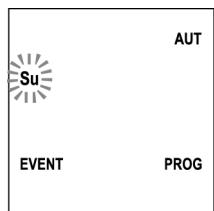
4. Mit den Tasten **UP / DOWN** den Tag mit dem Ereignis auswählen, das kopiert werden soll, und zur Bestätigung die **MENÜ**-Taste drücken. Das Display zeigt das Ereignis Nummer 1 an.
