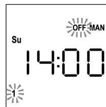
4. Através das teclas **UP** e **DOWN** selecionar o estado **ON** (ativado) ou **OFF** (desativado) do canal, pressionar **MENU** para confirmar e passar ao canal seguinte.
