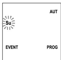
4. Mit den Tasten **UP / DOWN** den Tag auswählen, an dem ein Ereignis gelöscht werden soll, und zur Bestätigung die **MENÜ**-Taste drücken. Das Display zeigt das Ereignis Nummer 1 an.
