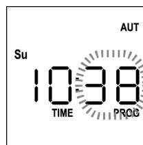
7. Mit Hilfe der **UP**- und **DOWN**-Tasten die Minuten einstellen und zur Bestätigung die **MENÜ**-Taste drücken. Der Schriftzug **TIME** blinkt 10 Sekunden lang.
