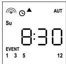
Diese Anzeige weist darauf hin, dass das eingestellte Ereignis einem Öffnungsbefehl ▲ für die Kanäle **1 3 5 12** am Sonntag (**Su**) um **8:30** Uhr entspricht.
