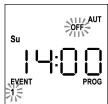
8. Régler les canaux qui doivent transmettre pour cet événement: Avec les touches **UP** et **DOWN** sélectionner l'état **ON** (actif) ou **OFF** (inactif) du canal, presser **MENU** pour confirmer et procéder avec la configuration du canal suivant.
