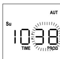
7. Stel de minuten in met behulp van de toetsen **UP** en **DOWN** en druk de **MENU**-toets in om te bevestigen.
