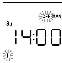
4. Tramite i tasti **UP** e **DOWN** selezionare lo stato **ON** (attivo) oppure **OFF** (disattivo) del canale, premere **MENU** per confermare e passare al canale successivo.
