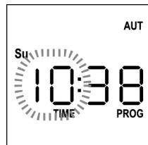
6. Stel het uur in met behulp van de toetsen **UP** en **DOWN** en druk de **MENU**-toets in om te bevestigen.
